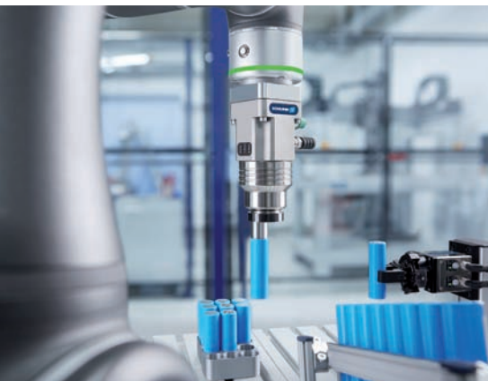
Rýchle a spoľahlivé uchopenie akumulátorových článkov: čas magnetizácie SCHUNK EMH, tu znázornený na jedнопólovom variante, je len 200 ms.
