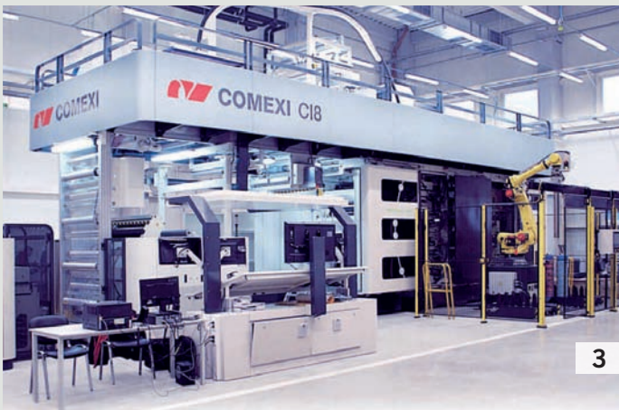
Obr. 4 Robot na automatizovanú výmenu všetkých tlačových foriem pri zmene zákazky v ofsetovej technológii
