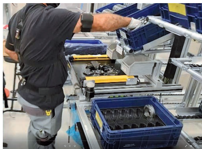
Obr. 3 Príklad umiestnenia snímačov na ergonomickú analýzu pomocou CAPTIV
